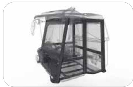
Nos cabines sont certifiées ROPS/FOPS, elles sont silencieuses et disposent d'un siège opérateur à suspension pneumatique équipé d'une ceinture de sécurité à trois points. Le strapontin a lui une ceinture ventrale à enrouleur. Les deux ceintures sont à enrouleur avec blocage automatique en cas de choc.
