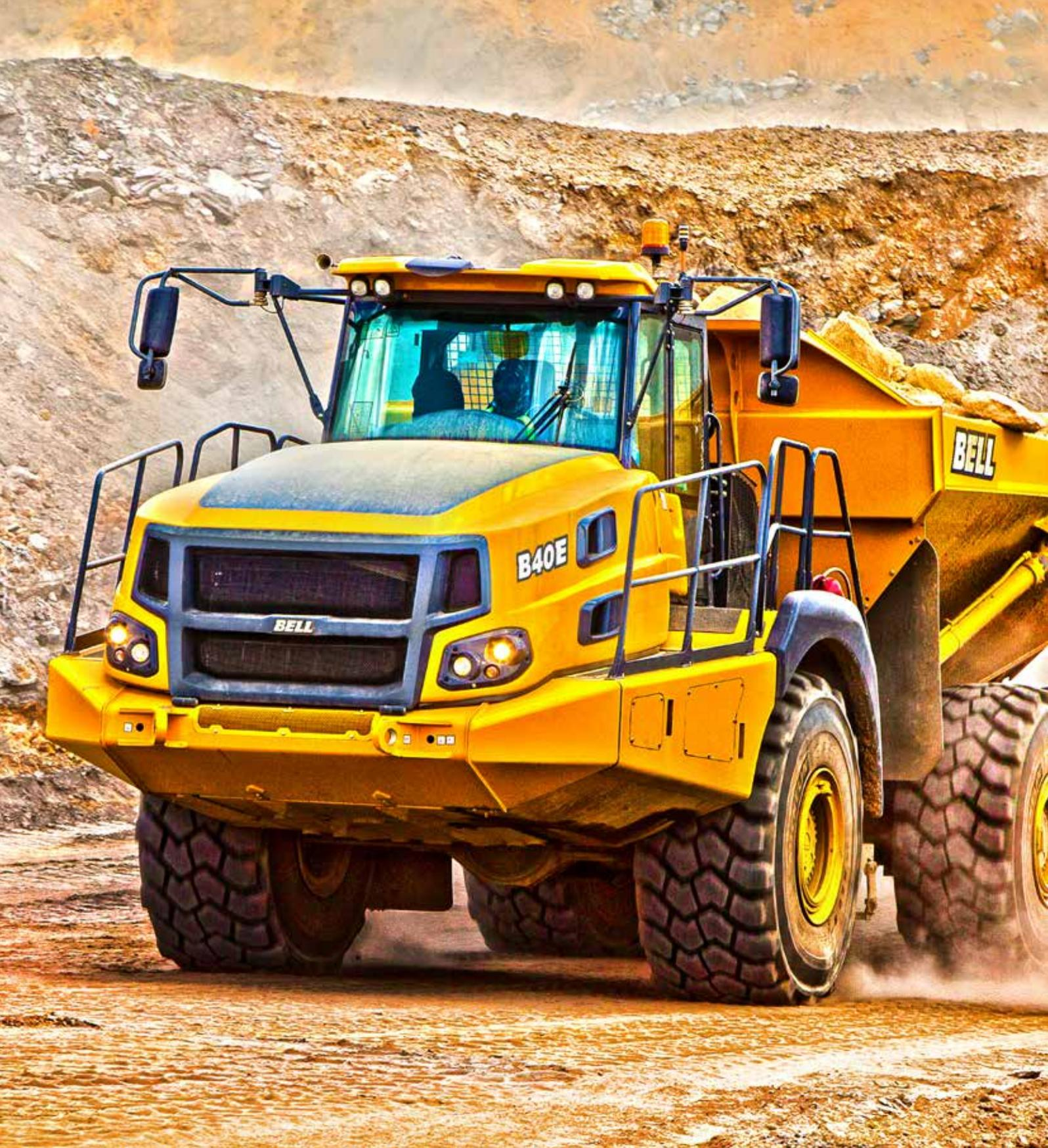
Afin d'optimiser les heures de bon fonctionnement, la série « E » bénéficie d'un système de diagnostic embarqué avec télétransmission automatique des données par satellite, vous permettant une gestion à distance de votre flotte. De plus tous les commutateurs électroniques sont étanches.
