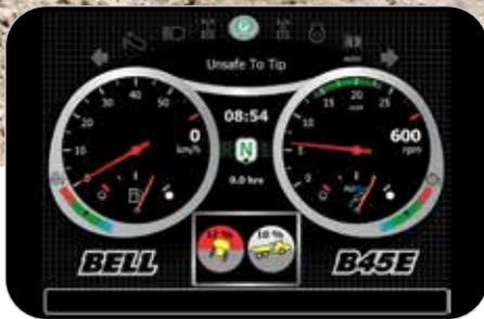
Les capteurs d'inclinaison longitudinale et latérale bloquent la commande de benne si la machine penche trop.
