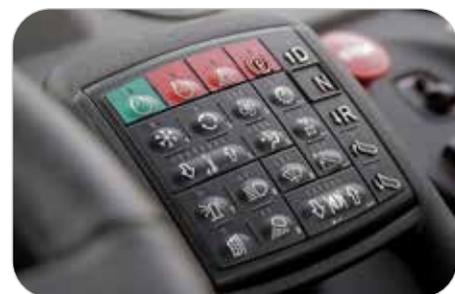
Le système de démarrage sans clé avec identification de l'opérateur et les codes d'accès évitent toute utilisation non autorisée de la machine.
