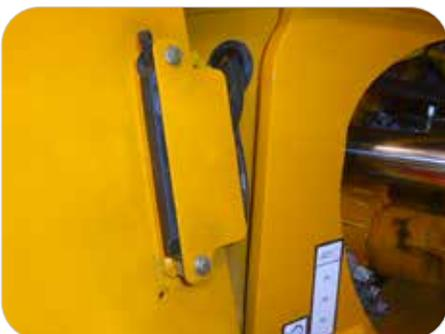
Les barrettes de graissage centralisées procurent un accès facile aux graisseurs placés dans des endroits difficiles à atteindre
