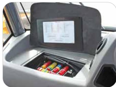
Un boîtier centralisé dans la cabine facilite le remplacement des fusibles. En outre, le plus faible nombre de relais, connecteurs et faisceaux renforce nettement la fiabilité.
