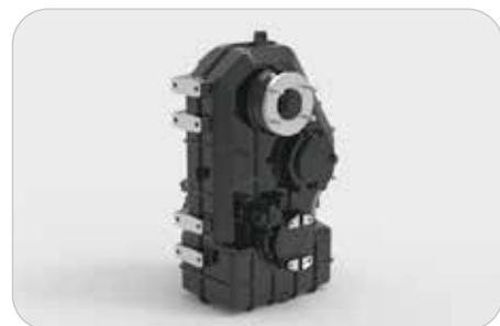
Le différentiel inter-pont assure, en fonctionnement normal, une répartition équilibrée de la traction sur chaque essieu. Lorsque les conditions se durcissent le blocage automatique de différentiel s'enclenche et transfère le couple aux roues offrant la meilleure adhérence.
