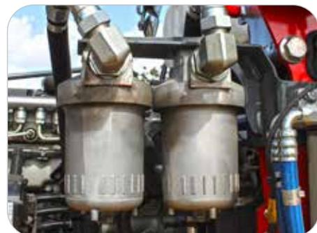
Nous proposons en option un filtre de transmission déporté. Le remplacement du filtre de transmission peut ainsi s'effectuer rapidement et proprement.
