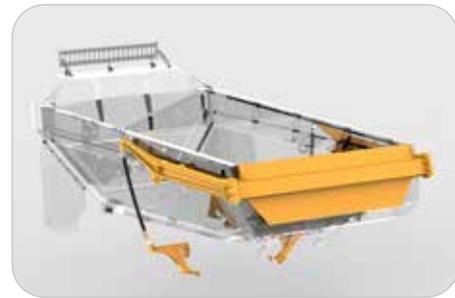
La porte arrière, disponible en option, réduit les pertes de matériaux durant le transport. Elle s'ouvre durant le vidage de la benne. L'emploi de lames de ressort, au lieu de chaînes, garantit une meilleure fermeture, et donc étanchéité, et minimise les pertes de matériaux, elle diminue sensiblement les bruits de claquement.
