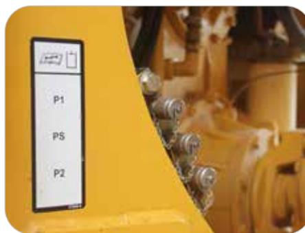
À partir des points de raccordement facilement accessibles, les techniciens procèdent plus rapidement à la recherche d'incident.
