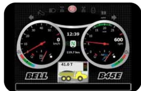
Le système exclusif de pesage embarqué donne en temps réel la charge de la machine. Une fonction réduction de vitesse en cas de charge excessive est programmable.
